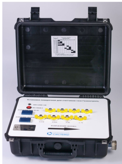
Установка для поверки счетчиков газа Газконтроль-6/Газконтроль-10
